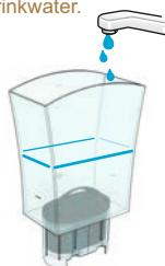
Wassertank hin- und herschwenken, um Luftblasen aus dem Filter zu entfernen.
